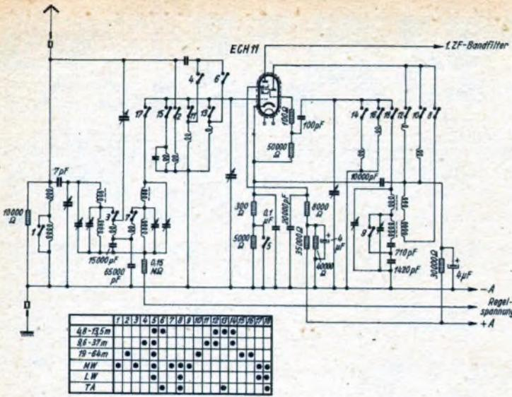
Bild 5. Im KW-Teil des Ingelen-Gigant 39 verwendet man für den kürzesten Wellenbereich die harmonische Oszillatorföwingung des nächsten Bereiches.
