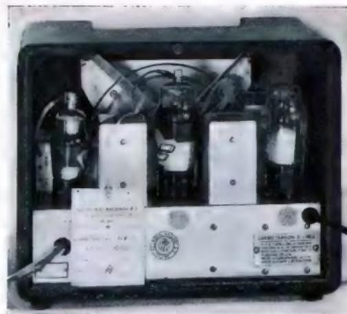
Blick in den rückwärtigen Aufbau des 6-Kreis-4-Röhren-Reflex-Supers.
