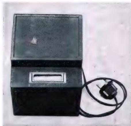
Das selbstgebaute Wattmeter in seinem neuen Kasten.
