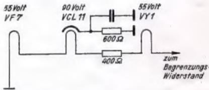
Bild 2. Die Einfügung der VCL 11 an Stelle einer VL 4 oder VL 1 in den Heizkreis.
