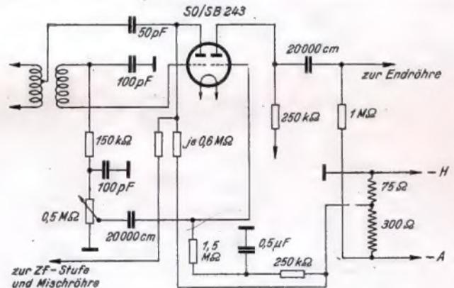
Bild 4. Ersatz der KBC 1 durch eine russische Röhre.
