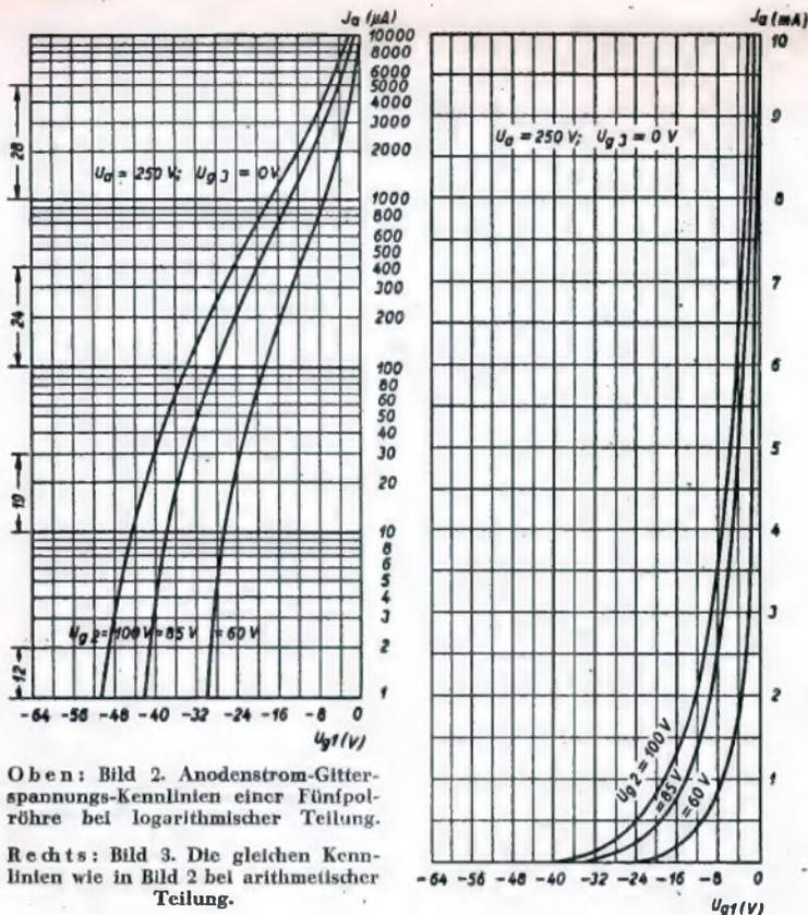
Oben: Bild 2. Anodenstrom-Gitterspannungskennlinien einer Fünfpolröhre bei logarithmischer Teilung.
