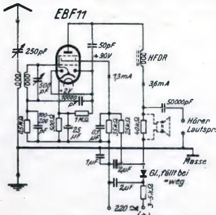
Bild 1. Die Schaltung des Einröhren-Reflexempfängers mit EBF 11.
