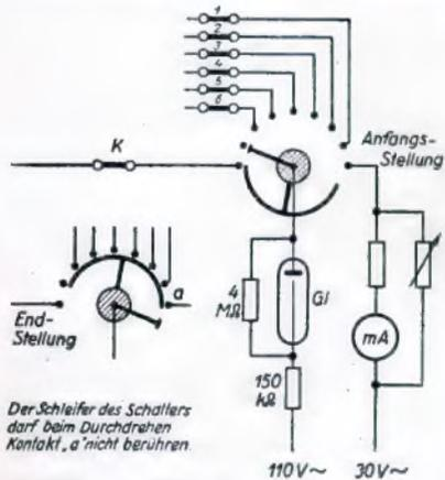
Bild 2. Schaltung der Zusatzrichtung für die Elektrodenschlußprüfung.
