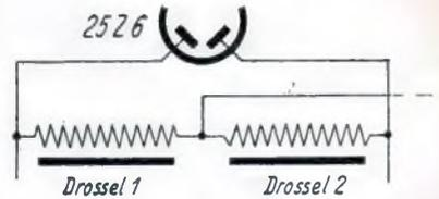
Bild 3. So lassen sich zwei Drosseln verwenden.
