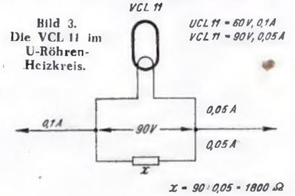
Bild 3. Die VCL 11 im U-Röhren-Heizkreis.
