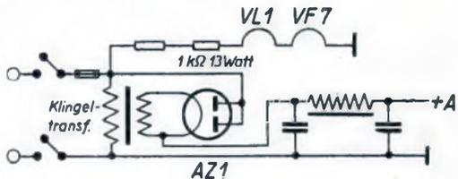
Erwähnt sei noch, daß sich dieses Verfahren bei jedem Allstromempfänger anwenden läßt, nur muß bei Gleichstrom der Transformator abgeschaltet werden und die Polarität des Netzes Beachtung finden. Die beiden Schaltungen Bild 7 und 8 zeigen den nötigen Umbau. O. Wehrmann.
