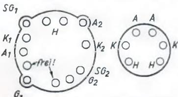
Oben: Bild 11. Sockelbilder der WG 34 und der Gleichrichterröhre.
