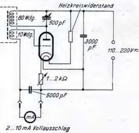
Links: Bild 18. Einfachste Meßschaltung für Kleinkondensatoren.
