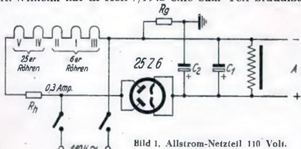
Bild 1. Allstrom-Netzteil 110 Volt.
