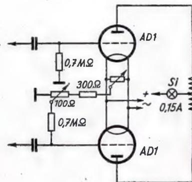
Links: Bild 1. Schaltung der Gegentakt-Endstufe mit nur einer Heizwicklung. Kathodenwiderstand und Regler sind hier bereits mit den sich bei dem Versuch ergebenden günstigsten Werten bezeichnet.
