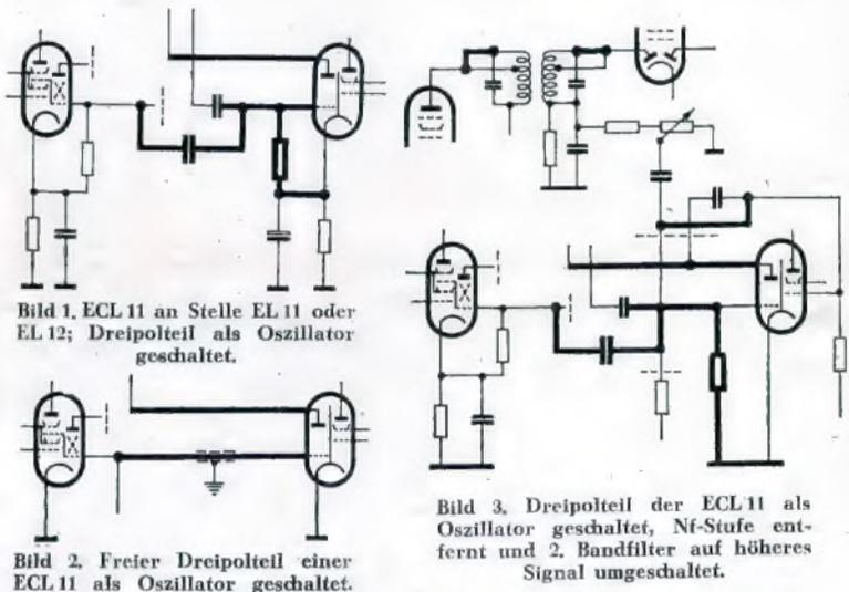
Bild 1. ECL 11 an Stelle EL 11 oder EL 12; Dreipolteil als Oszillator geschaltet.
