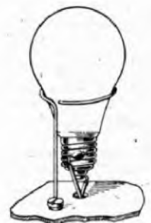
Bild 13. Stehende Schon- und Schutzlampe gegen Masse isoliert
