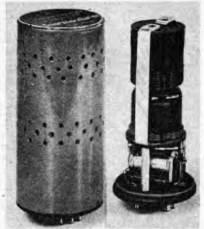
Bild 4. Quarzoszillator für Einbauzwecke (links ohne Schutzhaube, rechts mit Schutzhaube). Abmessungen: Höhe ohne Steckerstifte ca. 125 mm, Durchmesser ca. 60 mm
