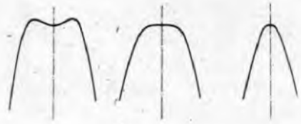
Bild 3. Resonanzkurven bei überkritischer, kritischer und unterkritischer Kopplung
