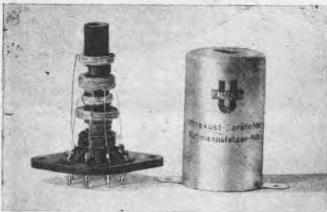
Bild 2. Der neue Spulensatz mit abgehobener Abschirmhaube
