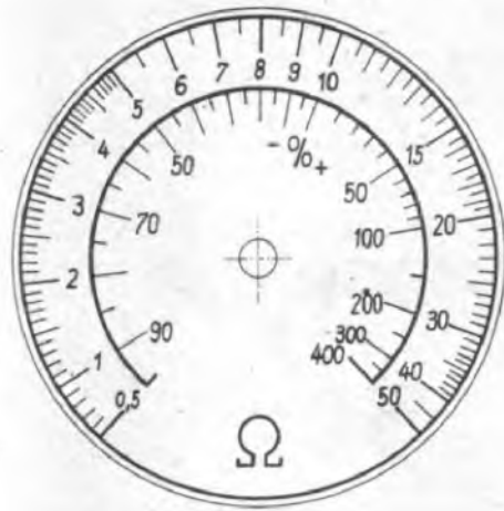
Bild 4. Zweckmäßige Skala für die Meßbrücke Die erzielbaren Meßbereiche erstrecken sich von \frac{1}{20} L_v bis 5 L_v bzw. \frac{1}{5} C_v bis 20 C_v
