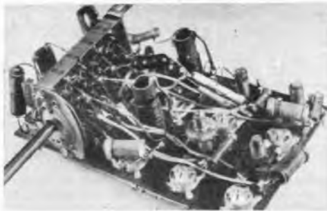
Bild 3. Wellenschalter und Spulenplatte des Philips-Allstrom-Superhets RA 4 U
