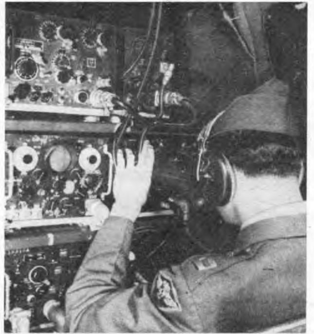
Bild 2. RADAR-Störgerät, während des Krieges im Flugzeug zur Störung und Anmessung feindlicher RADAR-Stationen verwendet
