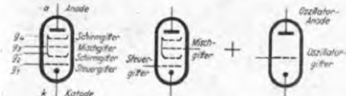
Links: Bild 30. Reihenfolge u. Bezeichnung der Gitter einer Mischhexode Bild 31. Getrennte Mischhexode (Mitte) und Oszillatortriode (rechts)
