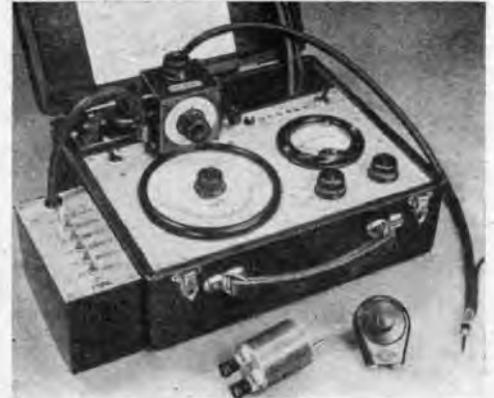
Bild 1. Das MPA-Gerät (Meß-, Prüf- und Abgleich-Gerät) mit sämtlichem Zubehör
