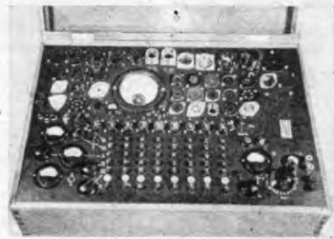
Bild 2: Außenansicht des fertigen Röhrenprüfgerätes
