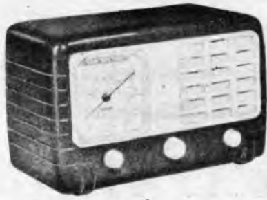
Bild 3. Ein-Bereich-Kleinsuperhet mit 4 Röhren und 6 Kreisen
