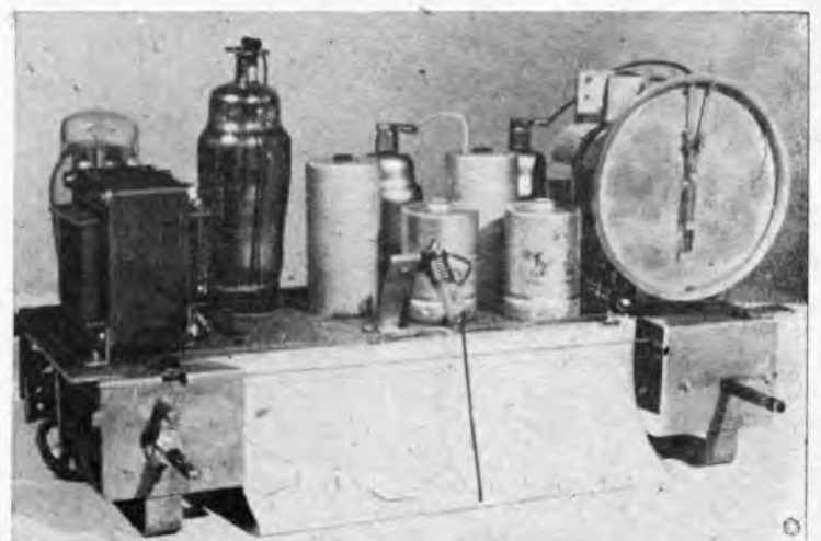
Bild 7. Chassis-Ansicht des Lorenz-Standardsuperhefts
