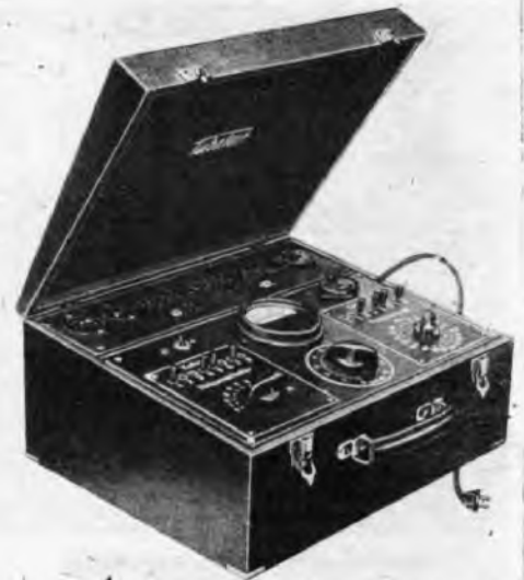
Bild 2. Außenansicht des Röhrenleistungsprüfers „Tubatest L 3“
