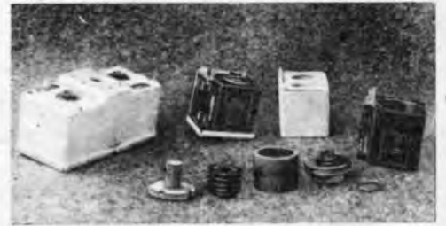
Bild 1. Topfkernspule MV 311 in einfacher und kombinierter Form
