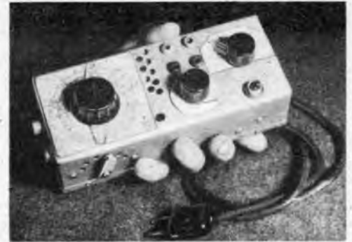
Bild 1: Außenansicht des „Multitester“ mit Frequenz-, L- und C-Skala links und davor angeordneten Bereichsschalter. In der Mitte befindet sich der Spannungsteiler mit den Ausgangsbuchsen, während rechts Tonfrequenzskala und Schalter angeordnet sind. An der linken Seite wurden Meßinstrumente, Clf-Buchsen sowie C- und L-Schalter untergebracht, ferner die beiden kapazitätsarmen Kippsschalter mit je 8 Kontakten für die Umschaltungen Clf-Gen. und Nf-Hf.
