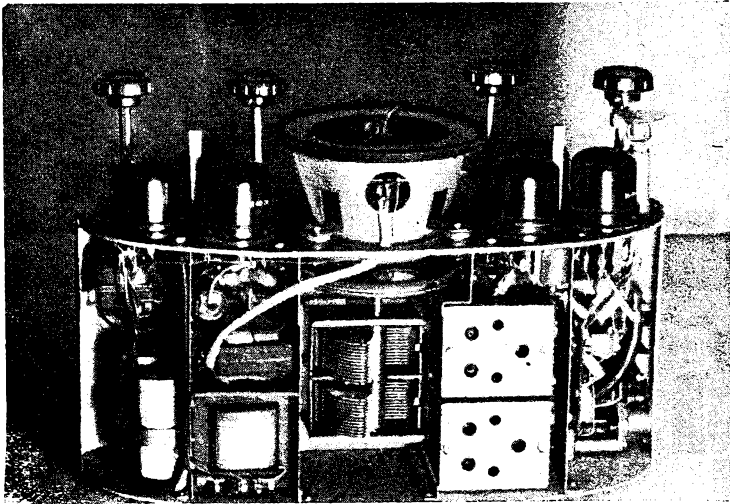
Bild 4. Chassis des Autosuperhets der Fa. Fahrenschreiber
