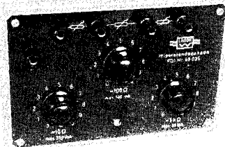
Bild 1. Die Außenansicht der Widerstandsdekade läßt die übersichtliche Anordnung der Bedienungselemente erkennen
