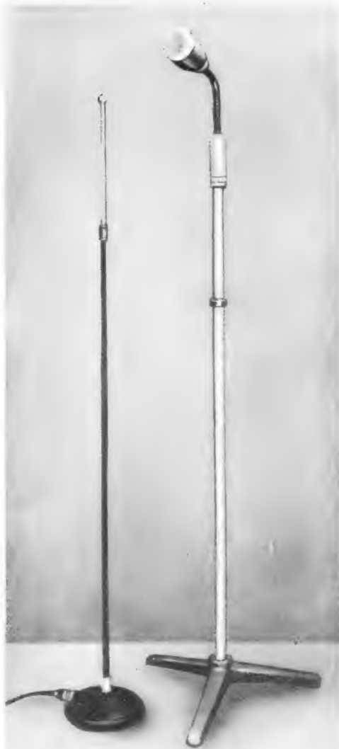
Bild 1. Das unsichtbare Tauchspulmikrofon DM 3 im Vergleich zu einem handelsüblichen Kondensatormikrofon
