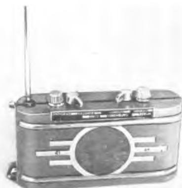
Bild 2. Dieser Taschenempfänger ist 150 x 86 x 40 mm groß. Er hat eingebauten permanent-dynamischen Lautsprecher und aufsteckbare Stabantenne
