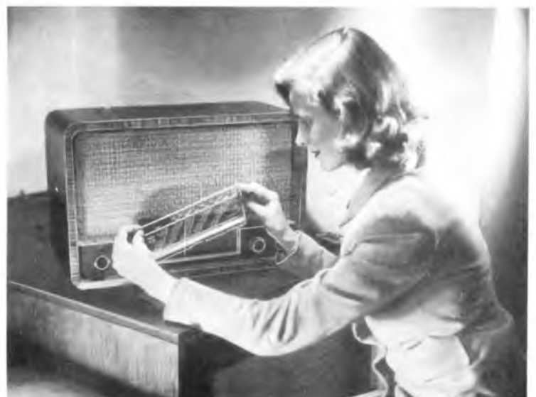
Bild 3. Philips Allstrom-Super BD 396 U mit leicht auswechselbarer Skala
