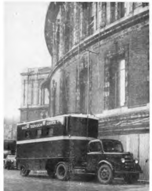
Bild 3. Einer der neuen BBC-Fernseh-Aufnahmewagen, fahrbereit, mit aufgebauter UKW-Antenne. Die Sendungen können mittels Relaisstation drahtlos zum Fernsehsender übertragen werden.
