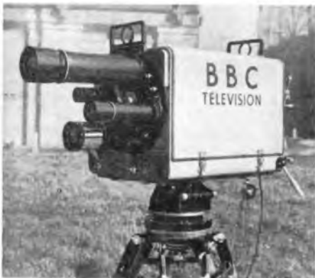
Bild 1. Die neuen im Aufnahmewagen verwendeten Fernsehkameras sind verhältnismäßig klein und leicht beweglich. Die Bildeinstellungen erleichtern vier Linsen mit verschiedenen Brennweiten, die man schnell mit Hilfe eines Linsenkranzes wählen kann.
