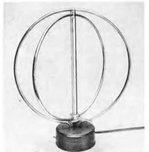
Bild 1. Fernseh-Innenantenne mit hohem Wirkungsgrad, mit der in New York mit üblichen Fernsehgeräten die sechs örtlichen Fernsehkanäle einwandfrei aufgenommen werden können.
