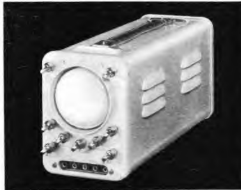
Bild 3. Kathodenstrahl-Oszillograf in Miniaturausführung
