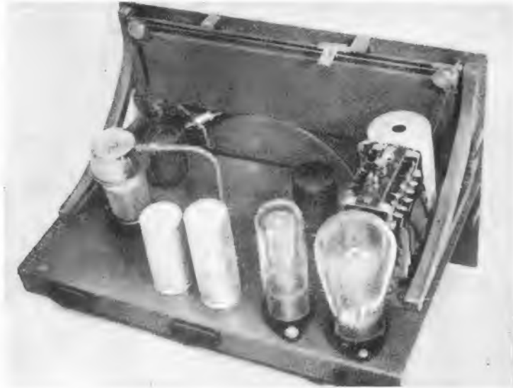
Bild 4. Rückansicht mit Oszillatorteil und Netzteil (rechts)
