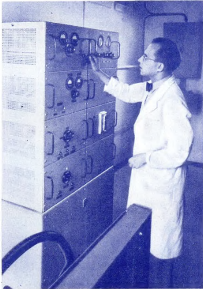
Links: Der erste hassische UKW-Sender (Bauart Telefunken) befindet sich auf dem Gelände des Frankfurter Mittelwellensenders an der Stadtgrenze in Frankfurt-Heiligenstock. Er überträgt versuchsweise das Programm von Radio-Frankfurt
