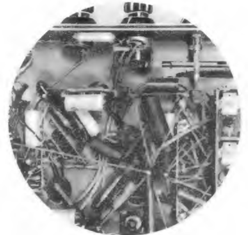
Bild 2. Typische KW-Verdrahtung mit Sammelpunkt-Masseverbindungen für Hf-Kreise
