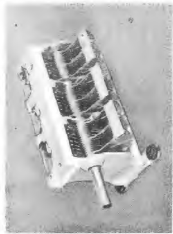
Bild 8. Der Dreifach-Abstimmkondensator (Rotor) besitzt eine Kapazitätsvariation von max. 20 pF (Anfangskapazität 16 pF, Endkapazität 36 pF).
