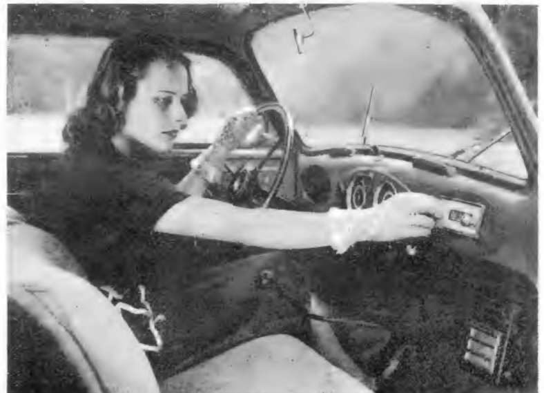
Bild 5. Besonders praktisch erweist sich beim Einbau der Blaupunkt-Autosuper 5A649, da der Empfänger- und Lautsprecher getrennt ist. Bei den meisten Wagen läßt sich der Empfänger- und Lautsprecher im rechten Handschuhkasten unterbringen.
