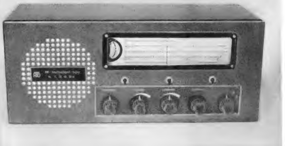
Bild 3. Der KW-Großsuper „Transatlant“ besitzt eine vorbildliche Anordnung der Bedienungsknöpfe und eine in Frequenzen für alle Bänder geeichte Linearskala
