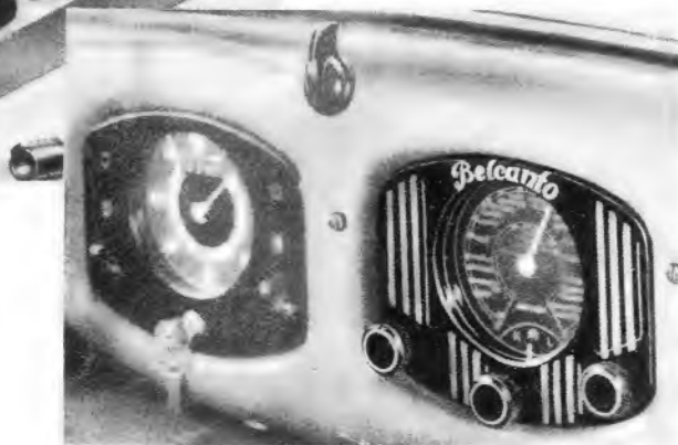
Rechts: Bild 7. Vorstufensuper „Belcanto“, im Armaturenbrett eingebaut
