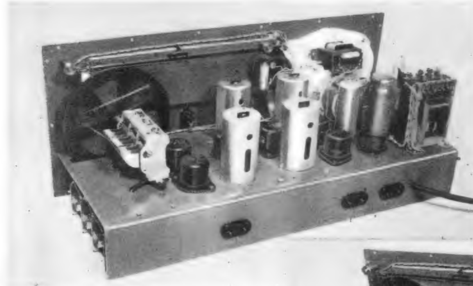
Bild 10 (oben). Der Chassisaufbau zeichnet sich durch übersichtliche Anordnung aller Einzelteile aus. Unterhalb des Dreifach-Kondensators befindet sich das Spulenaggregat. In Chassismitte sind die beiden Zf-Stufen eingebaut
