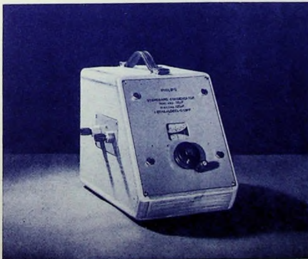
Bild 2. Die Philips-Standard-Drehkondensatoren erscheinen in einem handlichen Gehäuse und verwenden zwei Skalen für grobe und für feine Kapazitätsmessungen. Das Skalenfenster besteht aus Plexiglas, das gleichzeitig die Ableselinse enthält. Die Anschlüsse sind seitlich angebracht und keramisch isoliert. Ein Trägergriff erleichtert die transportable Aufstellung im Labor.
