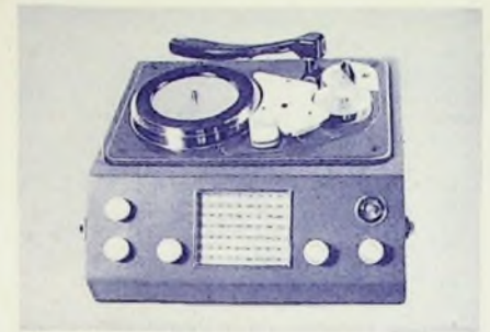
Bild 1. Das Tonaufnahme- und Wiedergabegerät „Reporter W 101“ der Fa Reichhalter & Co verwendet ein amerikanisches Stahl Drahtsystem. Es können auch Schallplatten abgespielt, auf Stahl Draht aufgenommen werden, da ein Kristalltonarm angeordnet ist. Das Gerät besitzt ferner Aussteuerungskontrolle mit Hilfe des Magischen Auges und erscheint in praktischer Kofferform.
