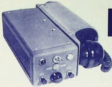
Bild 1. Bedienungsgerät mit Hörekanal. Oben der Umschalter für Wellenwechsel mit Anzeigelampe, links unten Lautsprecher, Mitte (Einschalter und) Lautstärke-regler, rechts Krachtöler.
