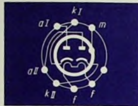
Bild 1. Sockelschaltung der Röhren EAA 11 und UAA 11
