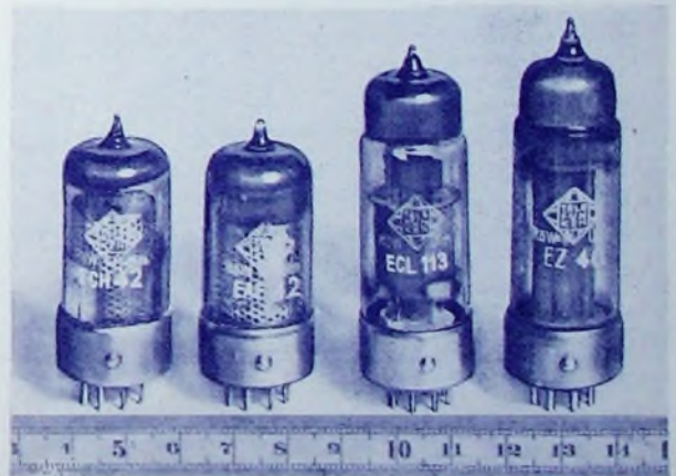
Bild 3. Die kleinen Abmessungen der Pico-Röhren gehen aus diesem Bild deutlich hervor
