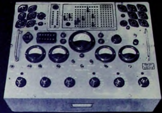
Röhrenprüf-, Meß- und Regeneriergerät Type RPM 370
