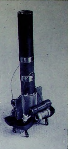
Bild 2. Innenaufbau eines Bandfilters für 10,7 MHz Zwischenfrequenz. Das Abschirmblech zwischen den beiden Kreiskondensatoren verringert die kapazitive Kopplung der beiden Abstimmkreise.
