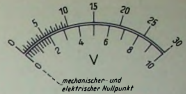
Bild 59 Völlig lineare Skala des Röhrevollmeters nach Schaltung Bild 58.
