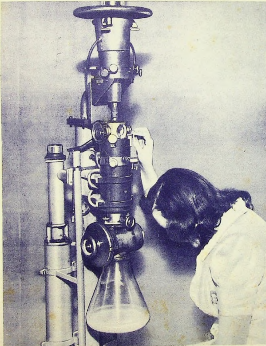
Eine Phase aus der Fabrikation von Kathodenstrahlröhren. Das fluoreszierende Pulver wird auf dem breiten Ende der Röhre angebracht, wodurch der Schirm entsteht, den der Elektronenstrahl zum Aufleuchten bringt!
