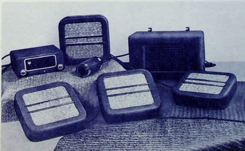
Bild 1. RFT-Omnibus-Empfänger 5 E 63, 5-Röhren-6-Kreis-Super für MW und KW
