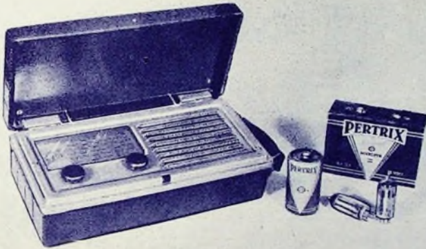
Bild 1. Metz „Baby“, der kleine, leicht und elegante Reiseempfänger gehört zu den besten Nachkriegskonstruktionen der deutschen Radioindustrie. Das Gerät in der Größe eines Zigarrenkistchens wiegt nur 1,8 kg einschl. Batterien
