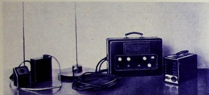
Bild 1. Gesamtansicht der kompletten transportablen Kleinsendeanlage „Teleport“
