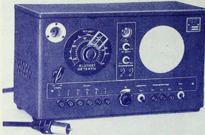
Bild 1. Außenansicht des „Elotast“-Gerätes, das eines der modernsten Fehlersuchgeräte der deutschen Industrie darstellt und durch zahlreiche Prüfmöglichkeiten in jeder Reparaturwerkstatt Zeit sparen hilft
