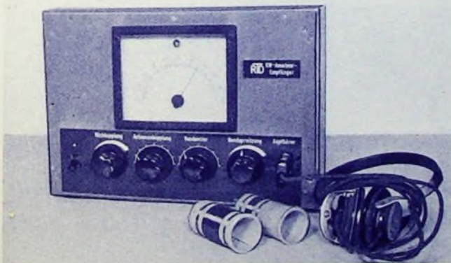
Bild 2. Die übersichtliche Anordnung der Bedienelemente kommt den Betriebsbedingungen für den Amateurjunk entgegen. Links befinden sich Netzschalter und Rückkopplungsregler, an die sich Antennenkopplung, Bandspreiz- und Bandspreizregler anschließen, während rechts das Buchsenpaar für den Lautsprecher angeordnet ist. Anschlüsse für Antenne und Erde sowie Lautsprecher liegen auf der Rückseite. Die Skala hat Gradenteilung und eine Skalenlampe zur Betriebsanzeige
