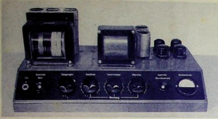
Bild 4. Vorderansicht des Verstärkers. Auf der rechten Seite befindet sich ausreichend Platz für einen Rundfunkvorsatz
