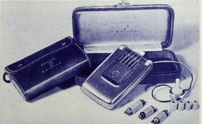
Bild 3. Auf kleinstem Raum sind hier sämtliche Teile des dreistufigen Verstärkers einschließlich Heiz- und Anodenbatterie untergebracht. Die Bedienung des Hörgerätes geschieht mittels zweier gefellter Drehknöpfe.
