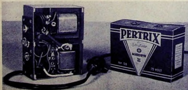
Bild 4. Der Einsatz-Netzteil zum Gerät Metz „Baby“ ist nicht größer als eine Mikrodyn-Batterie
