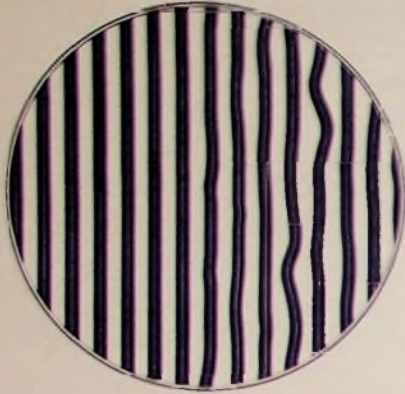
Bild 4 Die nach dem bisher üblichen Aufnahmeverfahren hergestellten Schallplatten verwenden einen gleichmäßigen, mechanisch erzeugten Rillenabstand, den man nur bei den verhältnismäßig selten vorkommenden großen Lautstärken voll ausnutzt. Bei mittleren und kleinen Lautstärken wird wertvoller Plattenraum verschwendet. Links sieht man sieben Rillen ohne Musik
