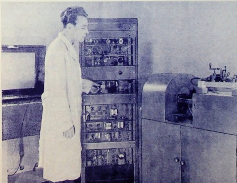
Bild 1. Die betriebsfertige Aufnahmeeinrichtung nach dem Füllschriftverfahren. Links das Magnetophon; in der Mitte das elektrische Gehirn der Anlage, das mit seinen 56 Röhren den eigentlichen Wachsschreiber (rechts) steuert
