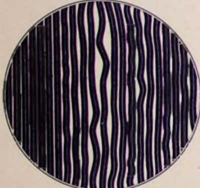
Bild 5 Schallplatten nach dem Rheinschen Füllschrift-Verfahren besitzen einen ungleichmäßigen, elektrisch gesteuerten Rillenabstand, den das elektrische Rechengerät der wechselnden Lautstärke feinnervig anpaßt. Es ergibt sich ein Raumgewinn bis zu 70%. Links: Sieben Rillen ohne Musik
