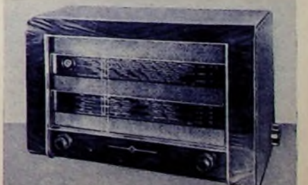
Bild 47. Telefunken-SpitzensUPER T 5000, ein 8-Kreis-9-Röhrengerät mit UKW, Hf-Röhre, KW-Spreizung usw.
