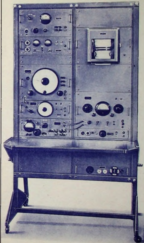
Zur automatischen Registrierung von frequenzabhängigen Dämpfungen und Scheinwiderständen aller Art
