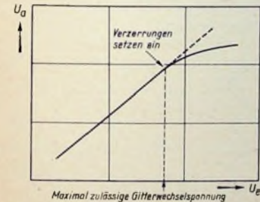
Bild 13. Ausgangsspannung in Abhängigkeit von der Gitterwechselspannung
