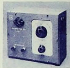
Das „Picometer“ mißt Kapazitäten von 0,1 ... 150 pF mit ± 2%
