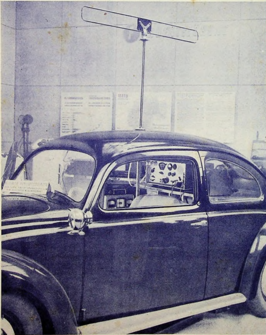
Auf der 16. Funkausstellung zeigte die Post im Rahmen einer großzügigen Ausstellung, die den einzelnen Aufgabengebieten der Post auf radio-technischem Sektor gewidmet war, u. a. einen kleinen Funkmeßwagen, der auf das modernste ausgerüstet ist. Er enthält u. a. einen Autosuper mit Feldstärkeanzeige, Störmeßgerät, Röhrenprüfgerät, Störmittalkoffer und eine vorbildlich ausgestattete Spezialwerkzeugtasche. Es sind ferner UKW-Meßempfänger, eine drehbare Antenne und eine Schalltafel eingebaut. Die Stromversorgung geschieht aus einem Sammler, den ein eigener Umformer unabhängig von der Wagenbatterie auflädt.
