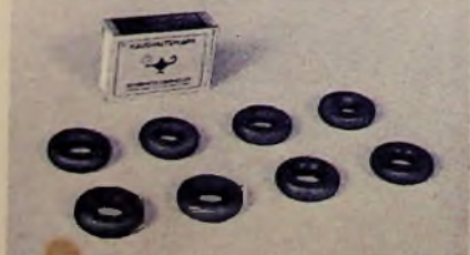
Bild 1. Hi-Eisenkerne für Ringkernspulen im Größenvergleich zu einer Zündholzschachtel
