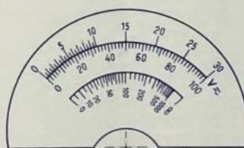
Bild 75. Dreiteilige Skala des Verbund-Röhrenvoltmeters nach Schaltung Bild 74
