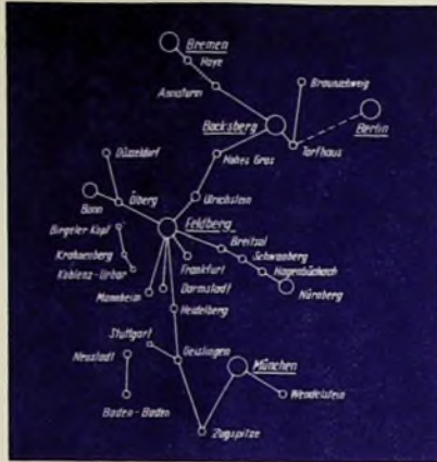
Bild 2. Das Dezi-Netz der Deutschen Bundespost überbrückt z. Z. etwa 2000 km Gesamtlängere Entfernung
