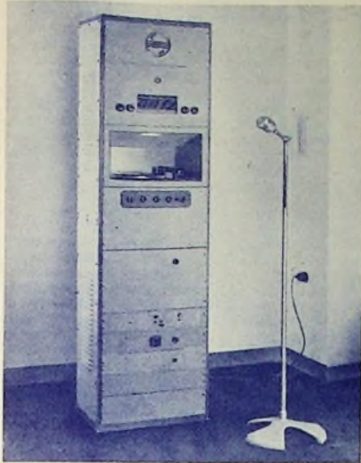
Bild 13. Philips Verstärkerzentrale in Gestell- aufbau m. Überwach- u. Aussteuerungsorganen
