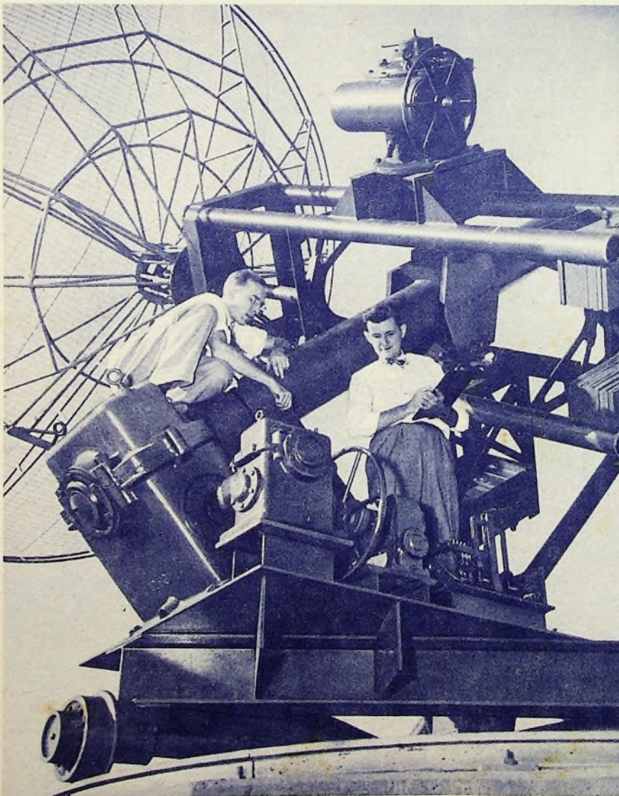
Amerikanische Wissenschaftler bemühen sich mit Erfolg neue Empfangs- und Sendegeräte zu entwickeln, die eine Erforschung des Weltalls mit Hilfe der Radio-Astronomie ermöglichen. Mit diesem Radio-Teleskop, das eine Parabolspiegel-Antenne von über 5 m Durchmesser verwendet, können die von der Sonne ausgestrahlten Schwingungen empfangen werden. Prof. Charles L. Seeger (links) und Direktor William E. Gordon von der Cornell Universität sind eifrig um die Auswertung der bisherigen Empfangsergebnisse bemüht. (Aufnahme: Cornell University)
