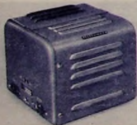
Bild 18 Eine 25-W-Endstufe in zweckmäßiger Tischbauweise von Telefunken
