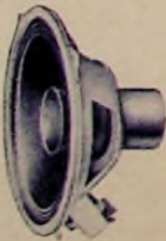
Bild 10. Alle neuen Feho-Breitbandlautsprecher benutzen eine kombinierte Hoch- u. Tiefton-Membran mit einer geradlinigen Abstrahlung innerhalb des Frequenzbereiches 30. 14.000 Hz. Die neuen Breitbandsysteme sind raumsparend und erscheinen für Sprechleistungen von 4, 5, 8, 12,5 und 25 Watt
