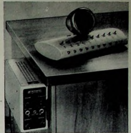
Bild 6. Chefstation einer Gegensprechanlage, bei der die Leitungswahl durch Kippschalter geschieht. Der Verstärker wird durch Rundfunkteil befindet sich seitlich am Schreibtisch.
