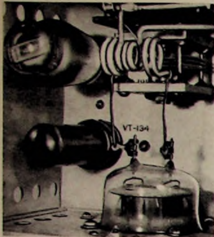
Bild 7. Seitenansicht des 2-m-Senders mit dem Anodenkreis der Endstufe. In der Mitte zwischen den Gegenaktspulen befindet sich die schwachbare Antennenkreisspule
