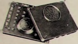
Bild 10. Der Anschlußkasten der Philips-Chefstation besitzt eine Mehrfachsteckdose mit 18 Kontakten
