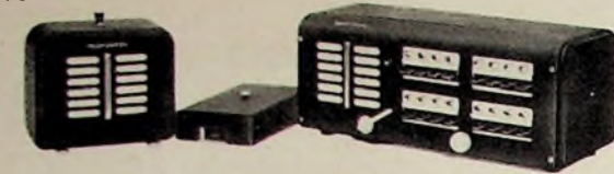
Bild 8. Telefunktensprechanlage mit Einzelstation (links), Anschlußkasten und Chefstation (rechts)
