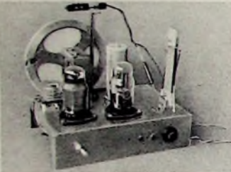
Bild 1. Beim Aufbau des Reflex-Zweikreislers ist auf gute Entlüftung der im Heizkreis angeordneten Vorwiderstände zu achten.
