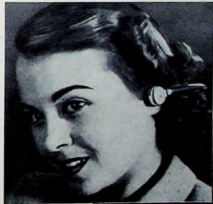
Links: Im Bügel des Miniaturkopfhörers ist die Dezimeterwellen-Detektor-Empfangsanlage untergebracht, die ohne Antennen- und Erdanschlüsse auskommt
