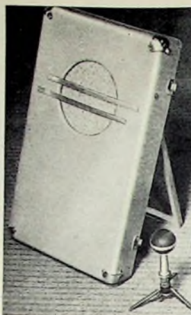
Das „Perfectone“-Magnetbandgerät enthält in einem mittelgroßen Koffer (Höhe 38 cm, Länge 25,5 cm, Breite 62 cm) eine vollständige Aufnahme- u. Wiedergabeeinrichtung mit Verstärker, Misch-einrichtung und Lautsprecher, der im Kofferdeckel untergebracht ist.
