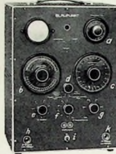
Vorderansicht — a) Hubregler; b) Verstimmungsskala für Bandbreitenmessung; c) Hauptabstimmung (Einstellung d Mittel-frequenz); d) Wahlschalter: FM-Betrieb, AM-Betrieb mit Eigenmodulation, AM-Betrieb fremdmoduliert, unmoduliert; e) Eingangsregler der NI-Stufe; f) stufenloser Regler der HF; g) Stufenregler der HF; h) Eingangsbuchse für NI-Verstärker; i) Netzschalter; j) Ausgangsbuchse für HI
