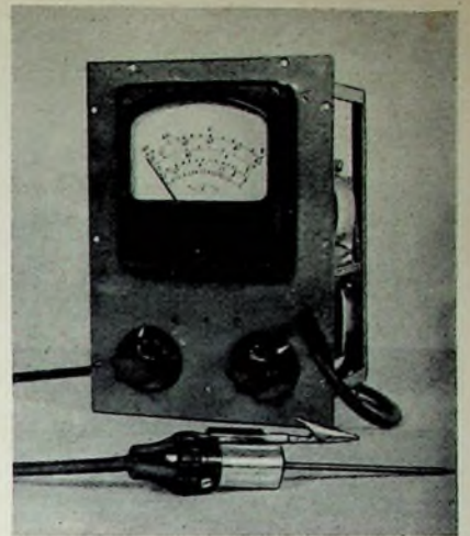
Bild 1. Gesamtansicht des Audion-Röhrenvoltmeters ARV 350. Im Tastkopf ist die Anzeigröhre untergebracht.
