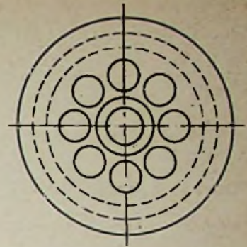
Bild 4. Röhrenanordnung des „Symmetrons“
