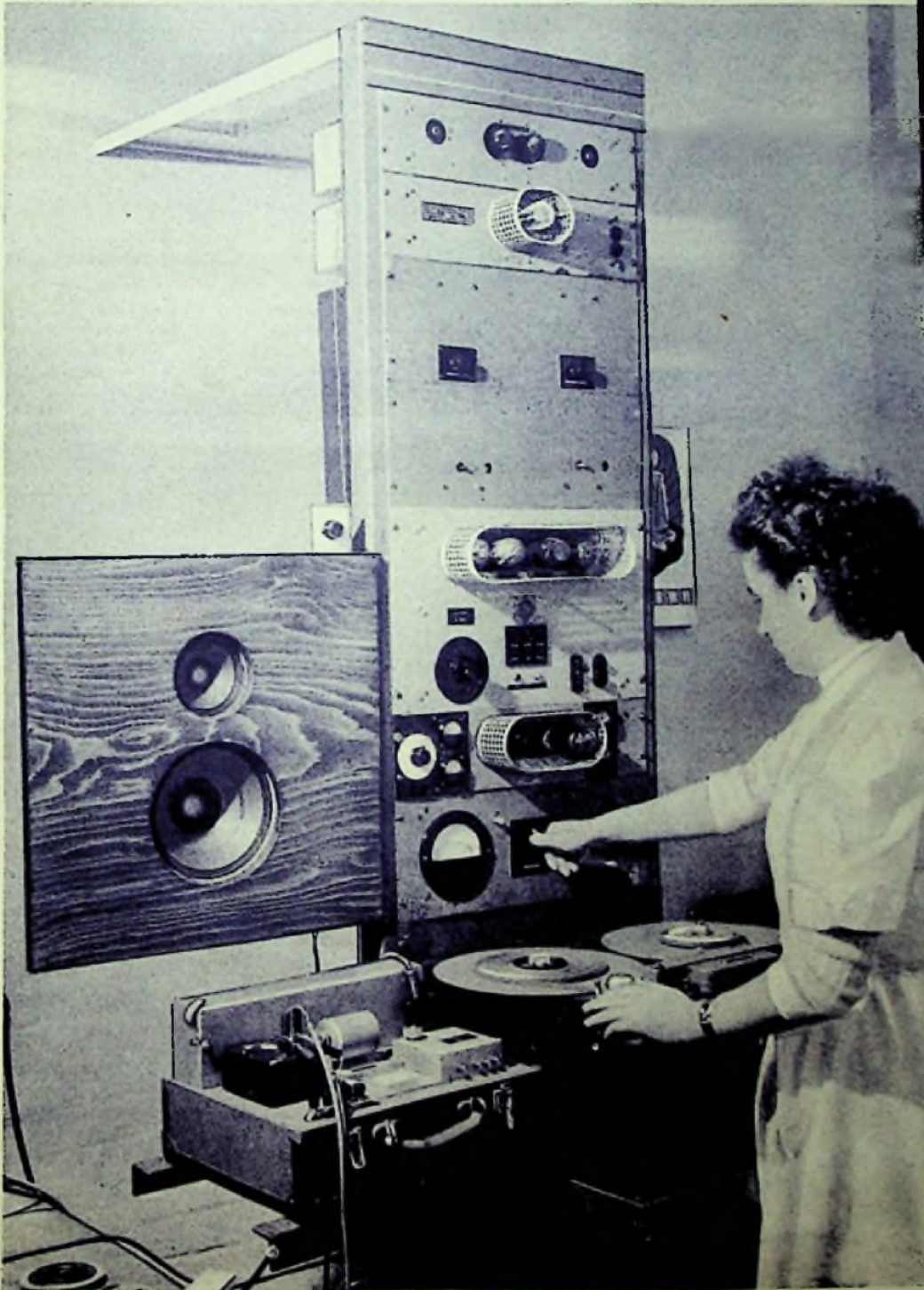
Mit dieser Bandprüfleinrichtung des Rundfunk-Technischen Instituts in Nürnberg werden alle Magnetophonbänder, die im Rundfunkbetrieb unserer Sender für die Schallaufnahme Verwendung finden, einer genauen und vielseitigen Prüfung unterzogen. Von der sorgfältigen Prüfung dieser Bänder hängt der reibungslose und einwandfreie Ablauf mancher wertvollen Rundfunkübertragung ab. (Foto: Carl Stumpf)
