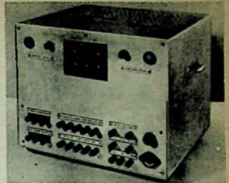
Ansicht des eingebauten Gerätes nach Schaltung D. In der Mitte oben, hinter einer abnehmbaren Plexiglastafel, befinden sich die Glühlämpchen-Sicherungen zum Schutz der Transformatoren gegen Heizfaden-Anoden-Schluß
