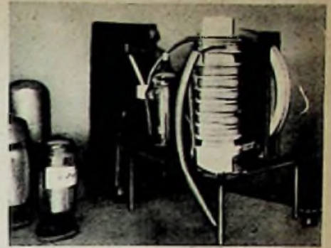
Bild 18. Gesamtansicht des Oszillator-Netzgerätes
