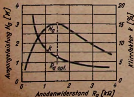
Bild 124. Abhängigkeit der Ausgangsleistung und des Klirrfaktors vom Anodenwiderstand bei einer Endtriode
