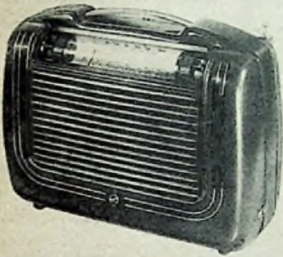
Beim 5-Röhren-7-Kreis-Super Blaupunkt „Riviera“ erfolgt die Ein- und Ausschaltung automatisch, wenn man das Skalen-Visier öffnet oder schließt
