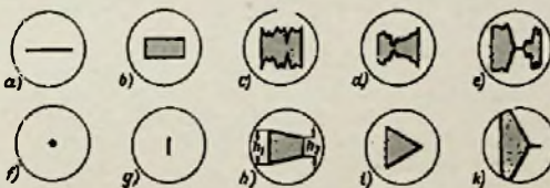
Bild 2. Schirmbilder: a + f = ohne Träger; b + g = nur Träger; c + h unter 100%; d + i = 100%; e + k = über 100%
