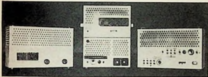
Gerätegruppe mit Verstärker KV 51/S (Frontansicht) links, Kino-Kraftverstärker K II (Mitte) und Universal-Kraftverstärker KV 51/E (Rückseite) rechts
