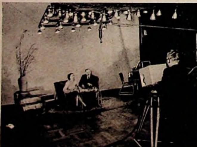
Blick in das Berliner Behelfs-Fernseh-Studio des NWDR. Zur Ausleuchtung der Spielfläche dienen Oberlichter (Philips Speziallampen) sowie eine Reihe von kleinen und großen Scheinwerfern; vorn rechts eine Fernsehkamera (Foto NWDR)
