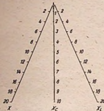
Bild 7. Nomogramm für die Beziehungen, die zwischen parallelgeschalteten Widerständen und seriengeschalteten Kondensatoren bestehen
