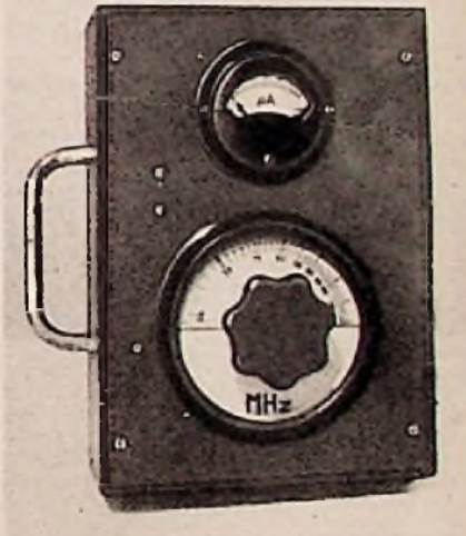
Bild 4. Außenansicht des einfachen UKW-Absorptionsfrequenzmessers
