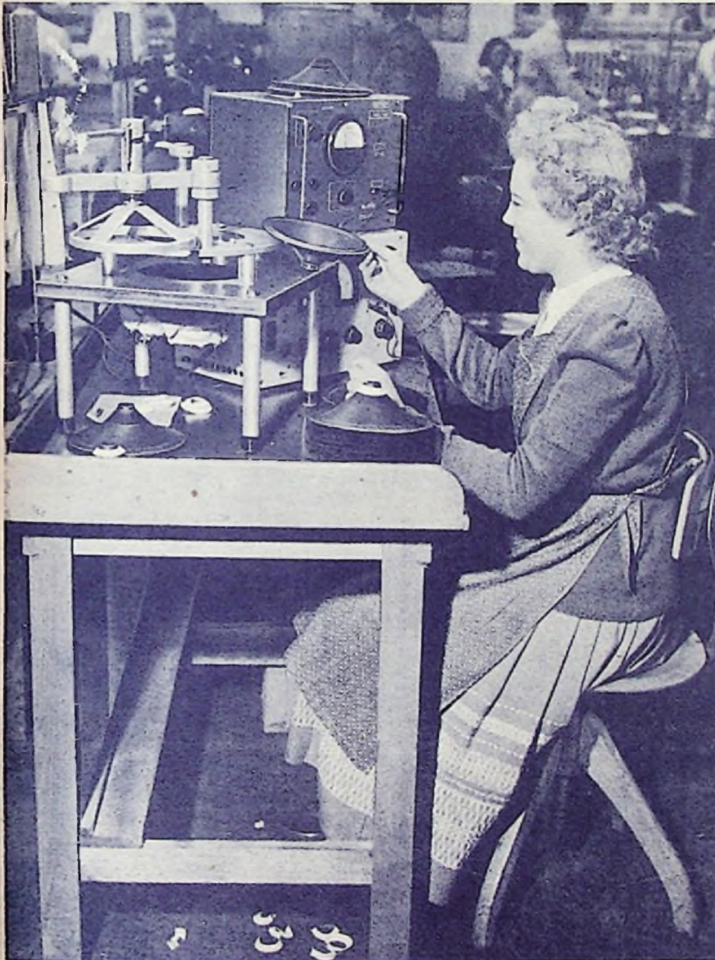
Lautsprecher-Membranen für Rundfunkempfänger werden am Prüfplatz vor dem Zusammenbau auf ihre Eigenfrequenz untersucht, damit auch in der Großserienfabrikation die klanglichen Eigenschaften genau eingehalten werden können. Ein aus einem Tongenerator gespeister Lautsprecher bläst die zu untersuchende Membran mit veränderlicher Frequenz an. Die Eigenresonanz des Prüflings ist an der größten Schwingweite erkenntlich; sie wird am Tongenerator abgelesen und auf der Membran verzeichnet. (Aufnahme aus der Telefunken-Fertigung: C. Stumpf)
