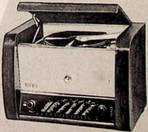
⑤ BRAUN-Phono-Super 770 WUK (AM/FM) 6 Röhren — 6 Kreise, eingebauter Plattenspieler, Magisches Auge, 4 Wellenbereiche, 4 gespreizte Kurzwellenbänder, 5-Watt-perm- dyn.-Lautsprecher, optische Wellen- breitenanzeige, optische Wellen- bereichsanzeige, hochglanzpoliertes Nubbaum-Edelholzgehäuse, Schwungradantrieb, Wechselstrom. Geh.-Abmess.: 570 x 380 x 355 mm. EB-Röhrensatz: ECH 42 EL 41 EF 41 EM 11 EBC 41 AZ 41
