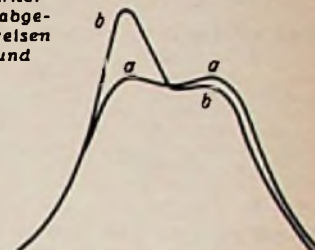
Bild 3. Resonanzkurve einer Verstärkerstufe. An Gitter und Anode liegt je ein einzelner Schwingungskreis. Kurve b unsymmetrisch durch zu große Gitter-Anodenkapazität oder Resonanzwiderstände
