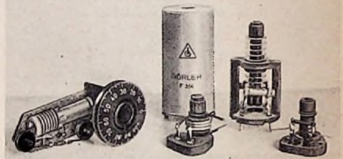
Görler UKW-Bauteile (Links UKW-Variometer F 313, daneben UKW-Eingangstransformator F 312, Zf-Bandfilter F 314 u. 10,7 MHz-Sperrkreis F 311)
