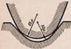
Bild 1. Nadel- und Rillenprofil für Normalplatten (78 Uml./min)
