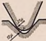
Bild 2. Nadel- und Rillenprofil für Schmalrillenplatten (Mikrogroove)
