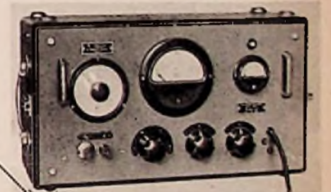
Bild 141. Verlustfaktor-Meßgerät Typ VKS von Rohde & Schwarz
