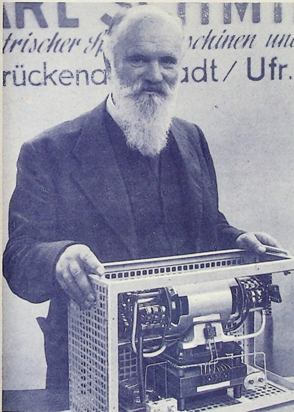
Auf der Münchener Elektromesse zeigte Dr. Ing. Karl Schmidt, der früher bei der C. Lorenz AG. Hochfrequenz-Maschinensender und Spezialmaschinen baute und zu den Pionieren des Maschinensenders gehört, diesen Gleichstrom-Wechselstrom-Umformer. Für die Herstellung der Wechselspannung wird eine rotierende mit Kollektoren und Schleifringen zusammengesetzte Widerstandsanordnung benutzt.
