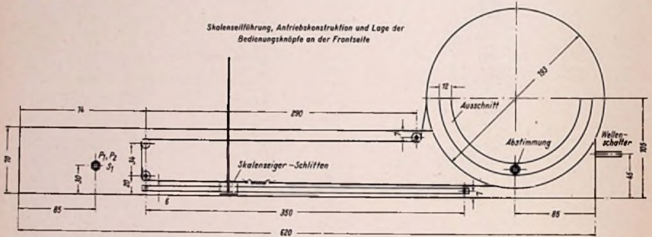
Chassisansicht von oben und Einzelteileanordnung auf der Montageplatte
