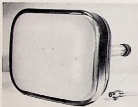
Bild 7. 35-cm-Rechteckröhre mit Strahlsystem (C. Lorenz AG)
